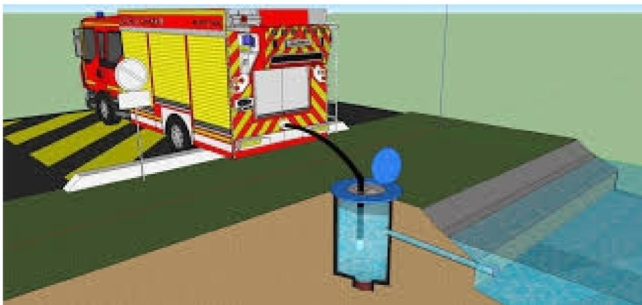
\* **Les puisards ou forages:** Ce sont des ouvrages aménagés sur des cours d'eau ou des nappes phréatiques dont la hauteur par rapport au sol doit être inférieure à 8 mètres.
