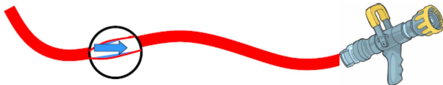
Le frottement des molécules d'eau sur les parois du tuyaux provoquent les pertes de charges
