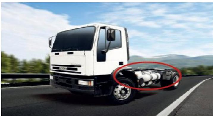
Sur les PL, les réservoirs GNV sont généralement situés sur les côtés (bas de caisse).
