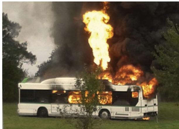
La réglementation n'impose pas de doubler la sécurité sur un réservoir GNV. **Le thermofusible installé sur une extrémité de réservoir peut ne pas se déclencher** si l'agression thermique se fait à l'opposé, ce qui peut entraîner une fragilisation de l'enveloppe, une montée en pression et explosion du réservoir.
