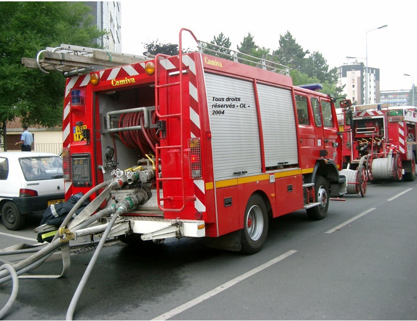
Ils permettent d'alimenter un engin pompe par deux établissements de 70mm. Sont généralement munis d'un clapet permettant l'obturation d'une des deux entrées en cas de rupture d'une alimentation.
